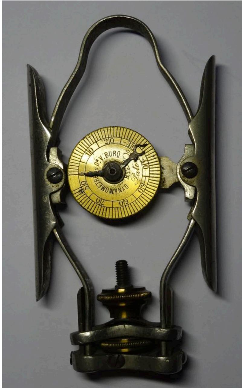
Fig. 3. Dynamomètre de Victor Burq vers 1876 (Collection particulière de l'auteur)
