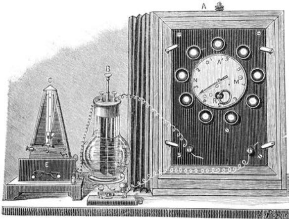
Figure 2 : Appareil de prise de vues séquentielles à neuf objectifs, muni d'un système de déclenchement électrique 1885. (Collection Walusinski)
